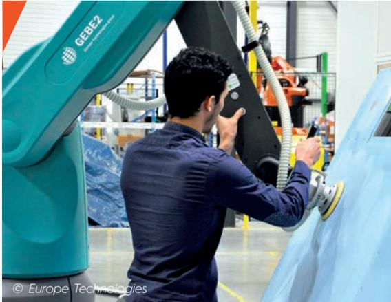
自动化本身就是一个独立的流程，需要成熟完善的专业技术。因此，领域内某些集成商的专业是打磨或机械加工。Emmanuel Bergerot解释道：“为适应需打磨的金属或复合材料、机器人安装场地的几何形状和环境、所需的生产率等，必须考虑到多种不同参数。”这是否为最重要的标准之一？“配合性指的是机械的弹性范围。机器人很精确，但不必精确到微米以内。为去除适当数量的材料，需调整与打磨机相关的设备的配合性，以达到所需的表面光洁度。”为实现这一点，工程部在车间进行初步测试。
