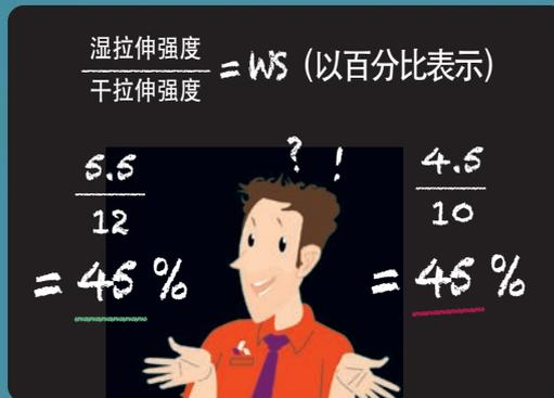
尽管左侧例子的湿拉伸强度比右例中的湿拉伸强度高，但第一种产品的WS百分比却偏低。由于干拉伸强度强烈影响所得的百分值，因此应优选一个绝对值。
