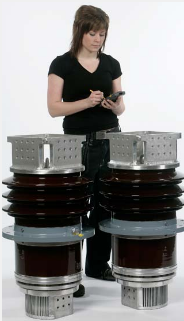
Högström genomföring typ GOH. Den här produkten är monterad på lågspänningssidan av så kallade generatortransformatorer. Strömmen i genomföringen är hög (upp till 25 kA) men spänningen är relativt låg, ungefär 36 kV.
