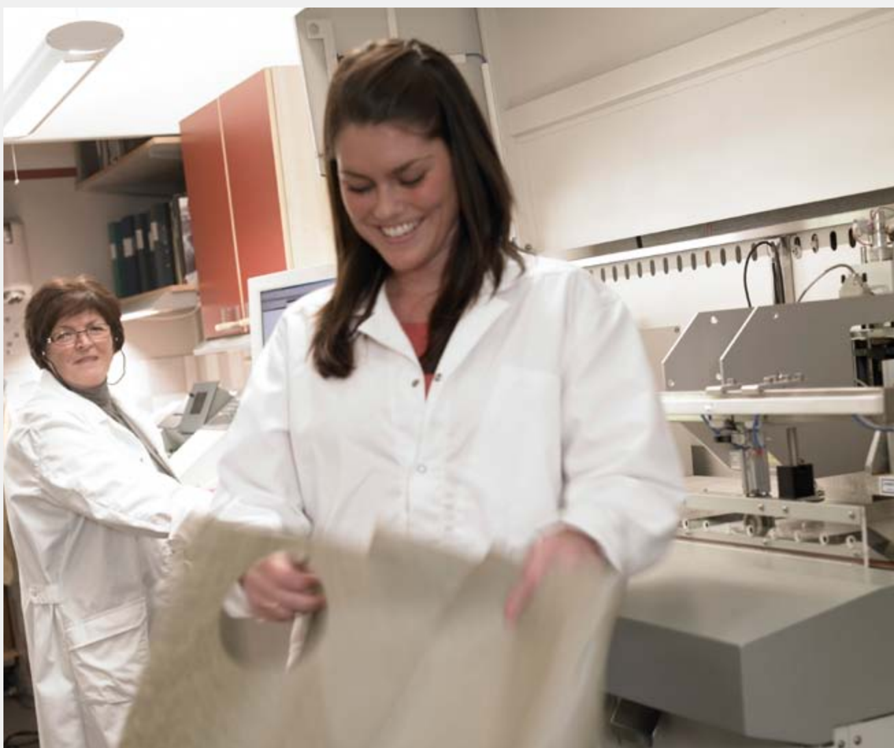
Anna Holmén och Ivana Dusic i laboratoriet för elektrotekniskt papper i Jönköping utför CEPI-provning. CEPI-CTS (Confederation of European Paper. Comparative Testing Service) görs två gånger per år för att säkerställa att rutiner och utrustning ger rätt resultat vid pappersprovning.
